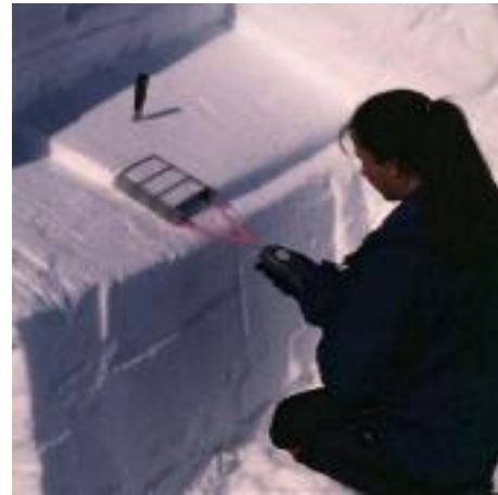
(d) Shear frame test
